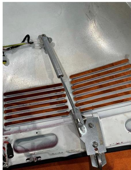
A l'aide d'un tournevis plat, décaler les bagues en acier à chaque extrémité des vérins sans les retirer, puis posez les et reclipsez les bagues.
