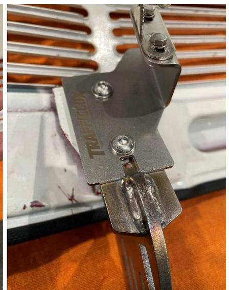
Positionner (dans le sens ci-dessus) les plaques glissantes du kit entrebâilleur, puis installer les fixations de vérins, crochets vers l'intérieur du capot.
