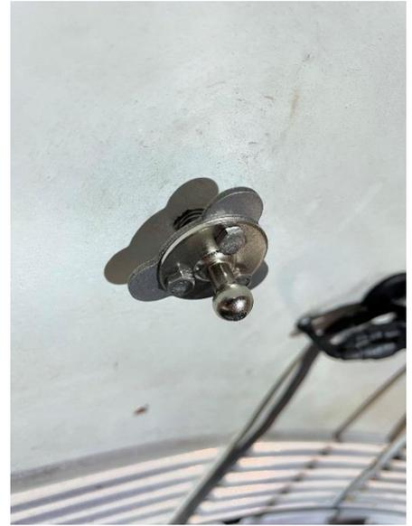
Après avoir retiré le capot, prenez le **sachet numéro 3** et remplacez vos 2 visseries extérieures d'éclairage de plaque d'immatriculation par les goujons fournis. Placer rondelle plate, puis la rondelle fendue, l'écrou et serrer le tout. Enfin, vissez les fixations à la main.
