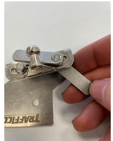
**Sachet numéro 2**, vis et rondelles sur le dessus, rondelles fendues et écrous en dessous, régaler au centre et serrer.
