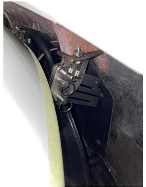
Installer les guides du kit entrebâilleur avec les verrouillages de position vers l'extérieur, **serrer légèrement les deux premières vis devant vous**, présenter le capot et mettre immédiatement les goupilles...
