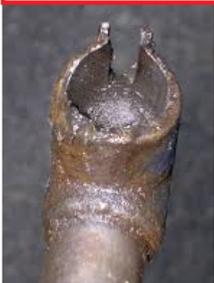
**Pas souvent mis en cause, mais l'usure peut provoquer un jeu d'avant en arrière.**
